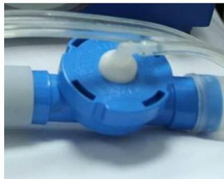
*Figura 34 – Válvula de Exhalación*
