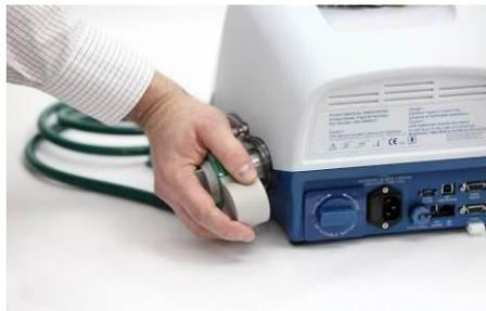
*Figura 13 – Instalación del mezclador de arrastre de Aire / Oxígeno*
